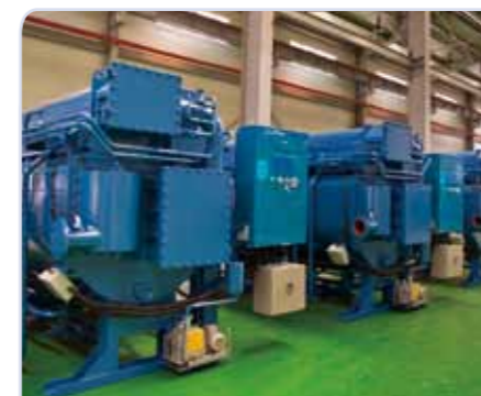
이란 BEHE SHT Residential Complex 직화식흡수냉운수기 5,880usRT
